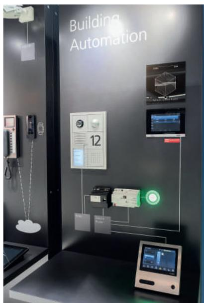
All IP-Türsprechsysteme integrieren die Türsprechstelle via IP in die Gebäudeautomation. Synergien werden dadurch sehr einfach realisierbar, z. B. die Visualisierung und Bedienung der Gebäudetechnik auf der Türsprechstelle innerhalb der Wohnung.
