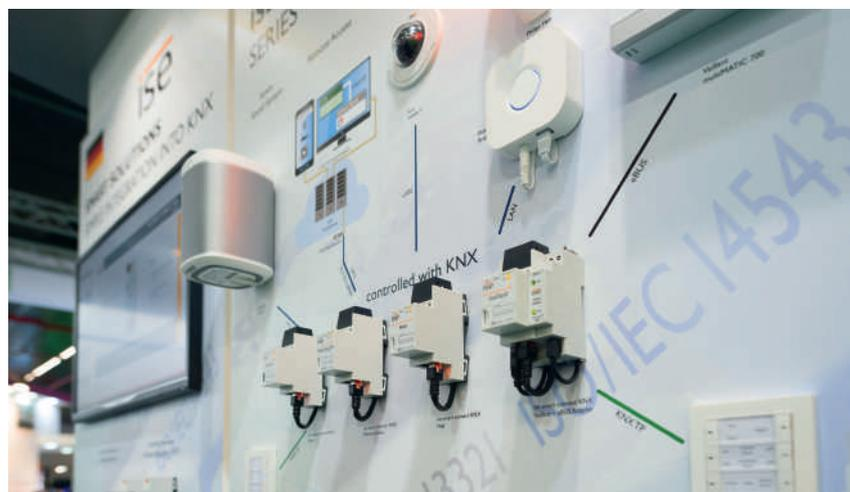
Gateways von ISE verbinden die IP-Welten von Sonos und Philipps Hue mit KNX und sind ein erster Schritt Richtung IoT.
