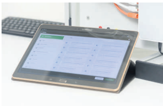
Die ETS Inside in der aktuellen Version ermöglicht die Konfiguration von KNX auf dem Tablet.
